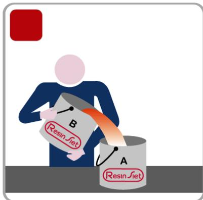
Versare il contenuto del componente B nel componente A, avendo cura di svuotare completamente il recipiente con l'aiuto di una spatola. Mescolare con cura manualmente o con trapano miscelatore a basso tenore di giri. Attendere 10/15 minuti e procedere all'applicazione della Resina impermeabilizzante.
